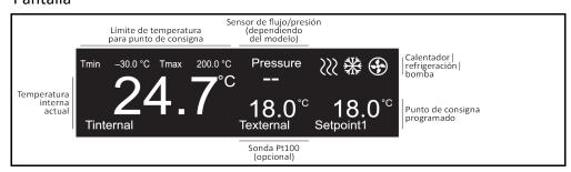
Pantalla Home: control de temperatura inactivo o visualización de un mensaje de error
