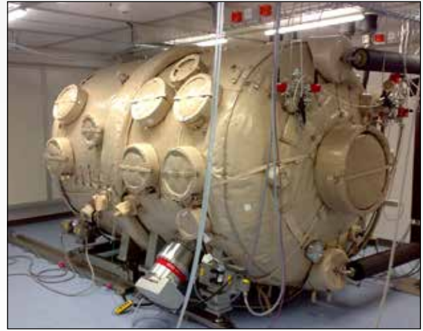
La chambre est isolée en conformité avec les exigences des salles blanches
